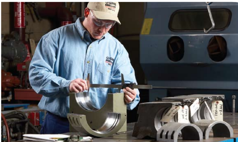
▲ Caixas de mancais são usinadas com precisão e cuidadosamente controladas para garantir alta performance
