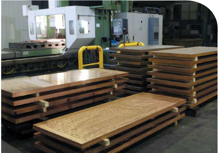
▲ Produzindo novas placas de molde em cobre usinadas com precisão
