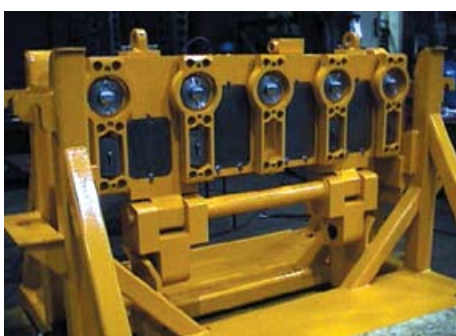
▲ Medidor de alinhamento eletrônico entre o molde e o segmento garante alinhamento preciso de lingotamento contínuo
