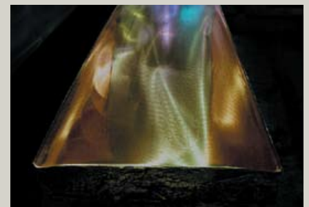
▲ Cobre revestido com níquel após 120.000 tons
